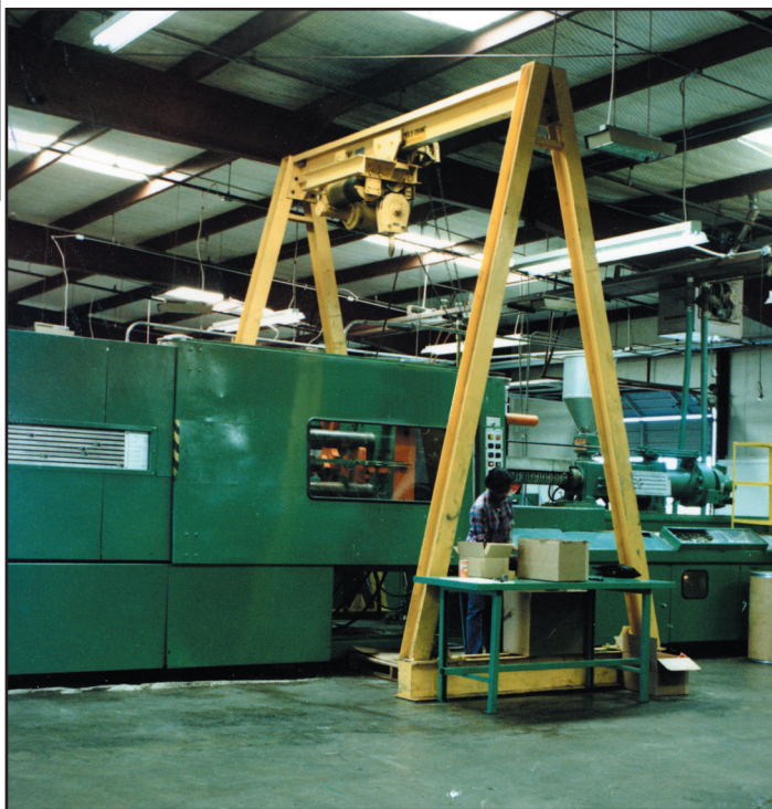
Uno de varios extrusores de moldeo por inyección utilizados para producir una gran variedad de productos.
