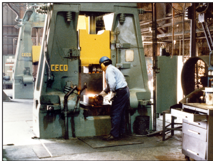
Uno de los diversos martillos capaces de producir piezas forjadas de hasta 50 lb.
